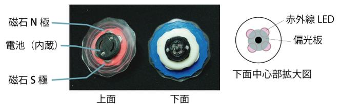
図5 コマの構造
