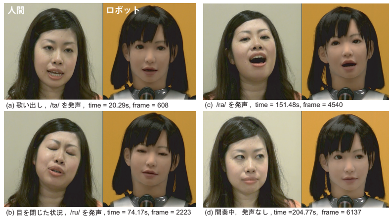
図 15 オリジナルの人間の歌い手(左)と提案する手法によって顔動作を制御した HRP-4C(右)
