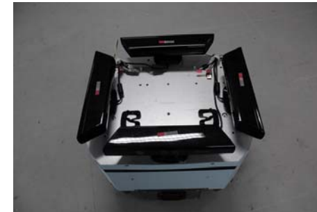
図 17 Microsoft Kinect を 4 台搭載した全方向環境計測ロボット
