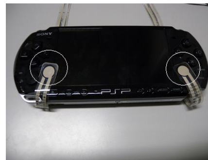
図3 圧力センサの使用イメージ（白○）
