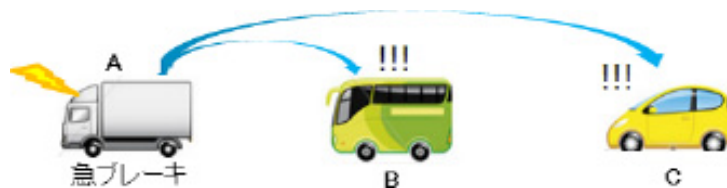
図 8 車々間通信による前方車両急ブレーキ警告システムのイメージ図
