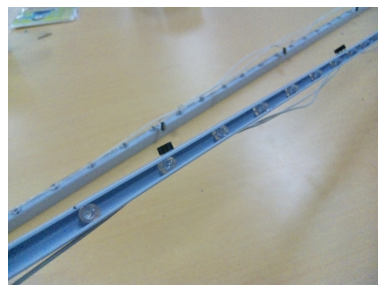
図 5 作成した赤外線 LED アレイ
