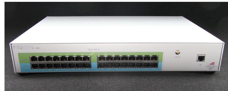
図 3 データ収集ユニット [サイズ: W 400mm x D 250mm x H 60mm]
