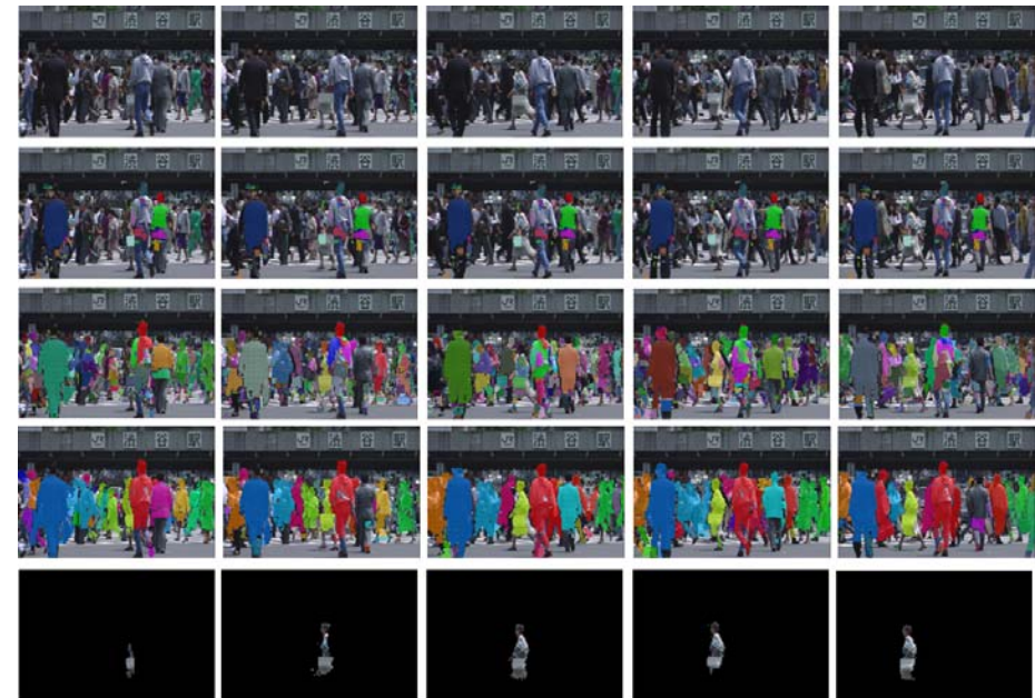
図6：混雑シーン(ITE)に対する結果 (a)：入力 (40frames) (b)：領域分割結果 (従来法[11]) (c)：過分割 (d)：領域分割結果(提案法) (e)：人物領域抽出結果
