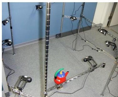
図 8 多視点カメラシステム Fig.8 Multi-view camera system
