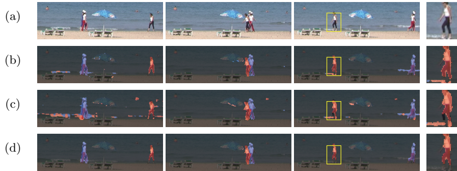
図 8 前景抽出結果の比較 . (a) 入力フレーム . (b) 推定背景を用いた閾値処理による背景差分法の結果 . (c) Zivkovic の手法による結果 . (d) 提案手法による結果 . 黄色で示した箇所を拡大すると , 提案手法では白波の動的背景が除去できている一方 , 女性の足の部分に欠けが見られる .
