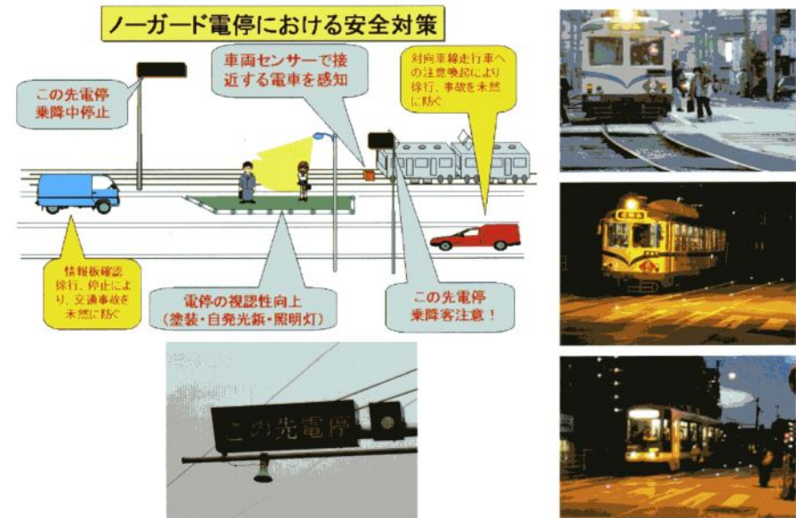
図-11 ノーガード電車停留所の安全支援システム Figure 11 The safe supporting system of a no guard train stop
