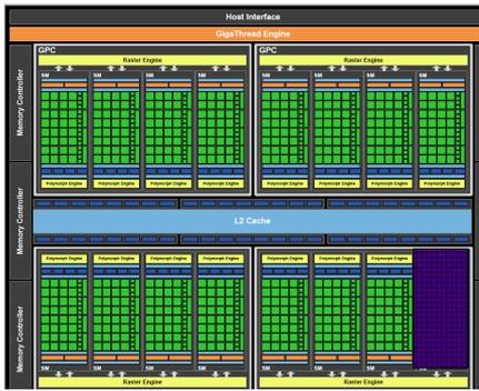
図 2: NVIDIA GeForce GTX 480 の構成
