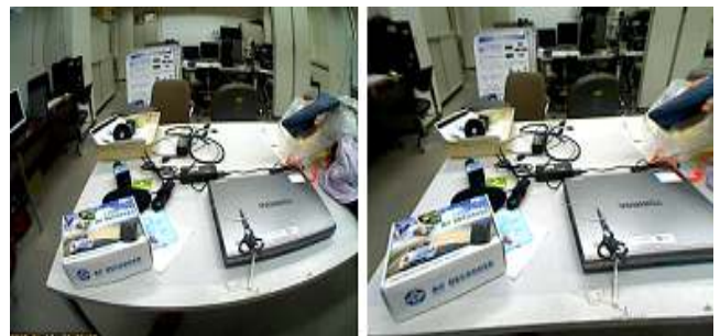
図5.キャリブレーションによる歪み補正 (左：元画像 右：補正画像)
