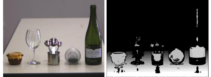
図3: オブジェクト表面の光学特性によるデータの欠落 (左: 画像, 右: 可視化したレンジデータ)
