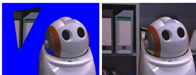
図 11: 形状情報 (計測) と形状情報 (推定) の統合結果
