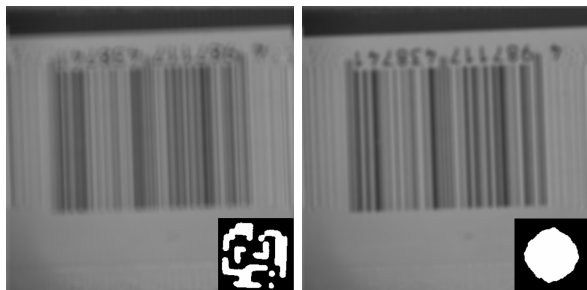
(a) 符号化開口の形状と、それによるぼけ画像 (倍率 M = 0.198 ) (b) 円形開口の形状と、それによるぼけ画像 (倍率 M = 0.143 )
