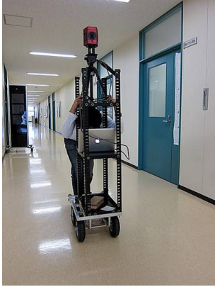
図 2 全方位カメラを装着した撮影台車の外観 (約 1.8m の高さに全方位カメラを設置)
