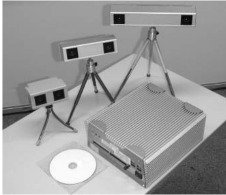
図 1 コビキタスステレオビジョンデバイス Fig. 1 Ubiquitous Stereo Vision Device (USVD)
