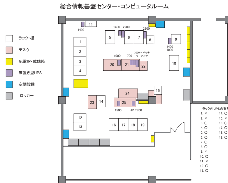
図1 ホストマシン室内のラック配置と床置き無停電電源装置配置
