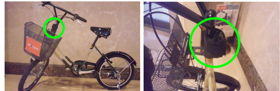
図4 レンタサイクルへのGPSの設置
