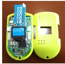
(a) : センサノード (無線通信モジュール, 照度センサの他に温湿度センサ, 加速度センサ, 有機 EL ディスプレイを搭載.)
