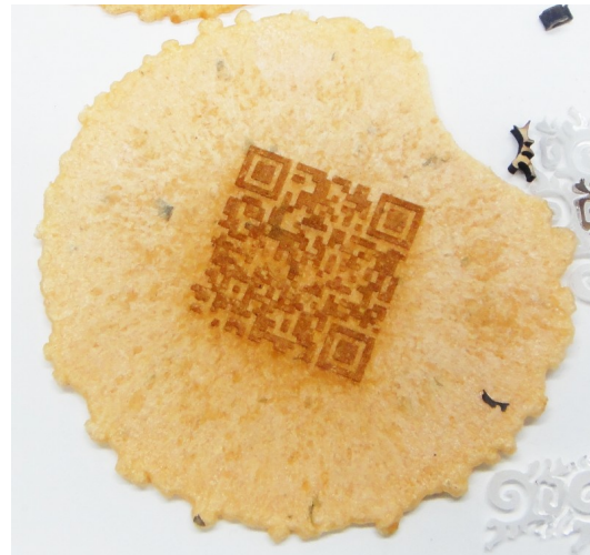
図7 二次元ビジュアルマーカを煎餅に印刷したもの Fig.7 Printing a 2D fiducial marker onto a rice cracker.
