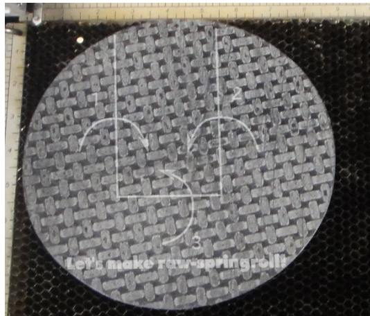
図6 ライスペーパーに手順書を印刷した例 Fig.6 Instruction manual is printed on a ricepaper.
