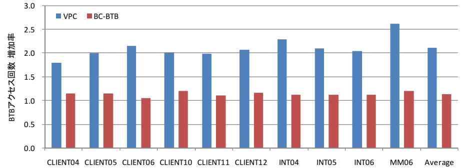
図 6 BTB の読み出し回数の増加率。 Fig. 6 Increasing Rate of BTB Access Count.
