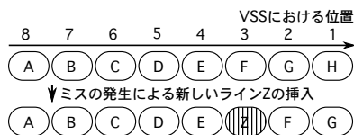
図3 VSS- K 挿入ポリシーを用いたキャッシュセット ( K = 3 )
