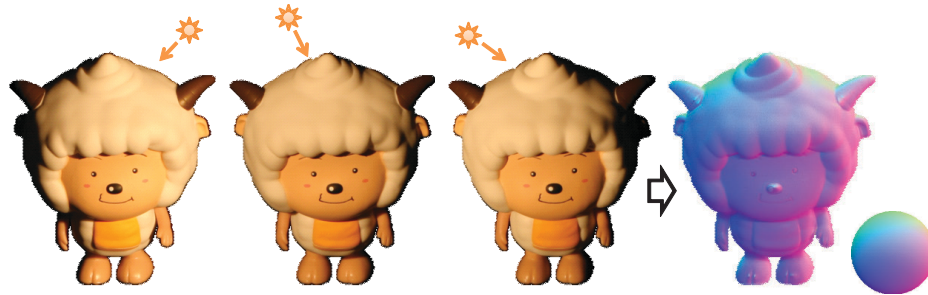
図3 照度差ステレオ。ランバート拡散反射面の仮定の下では、最低三つの異なる光源下で撮影された画像から法線ベクトルを推定できる。左の三つの画像はこれらの入力画像、右は推定された法線ベクトルをRGBで可視化したものである。右下の球は、法線ベクトルとRGBカラーコーディングの対応を示す： (R, G, B)^T = (\mathbf{n} + 1)/2 。
