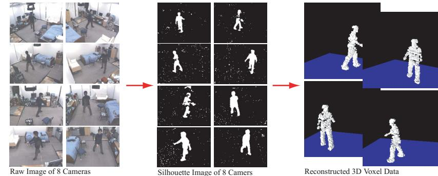
図 2 ボクセル復元の例
