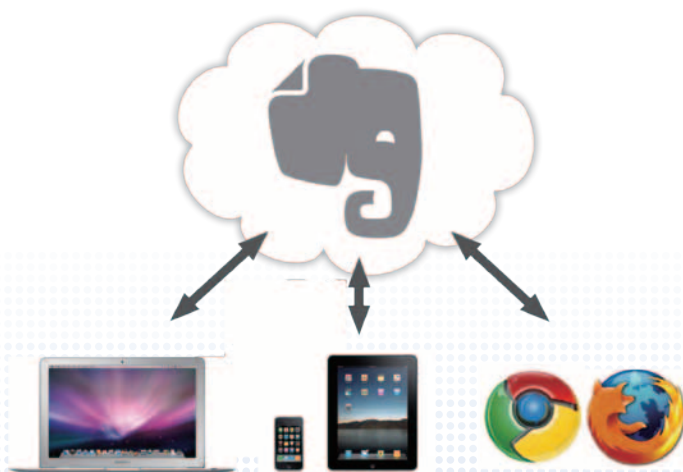
図-2 Evernote サービスの概念図。 情報はパソコン上の専用クライアント、ブラウザ、携帯端末などのすべてからクラウド上にアップロードが可能であり、相互に引き出すことが可能。画像文字認識機能などはアップロードされた Evernote サーバ上で実現している。
