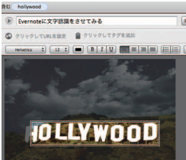
図-4 画像文字認識機能が動作している様子。 検索に対して画像内の文字列がヒットしているのが分かる。こうした機能はクライアント側ではなく、Evernote サーバ上で実現している。
