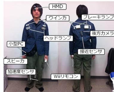
図 2 プロトタイプシステムの装着例
