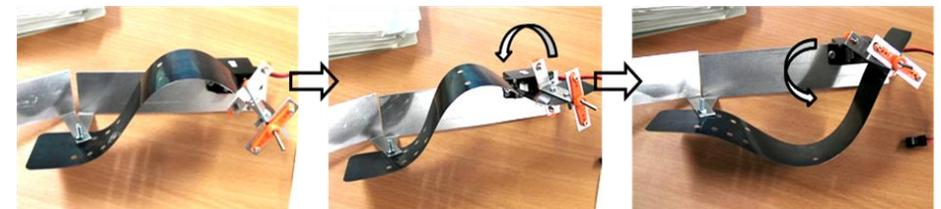
図2 飛び移り座屈機構の動作図
