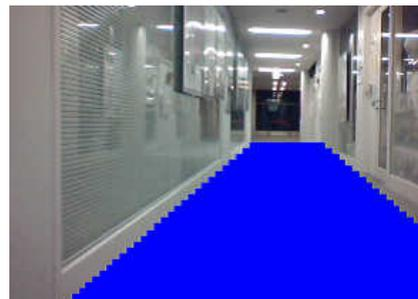
図 10 提案手法により抽出した床面
