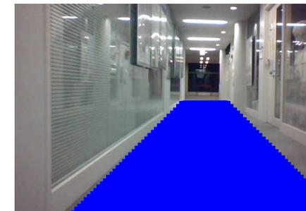
図 5 提案手法により抽出した床面
