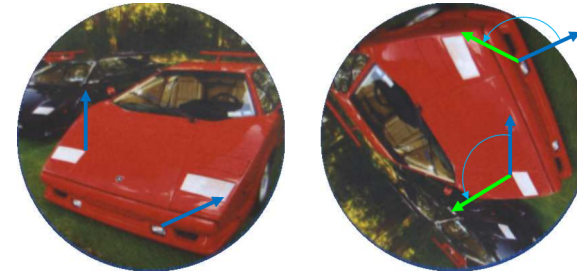
図 3 局所特徴の方向を利用したマーカーの方向推定。左:基準画像の局所特徴の方向, 右:入力検出した画像の局所特徴の方向。
