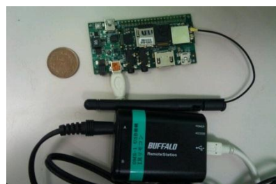
図 5 小型プロキシシステム を実装した Overo ボード
