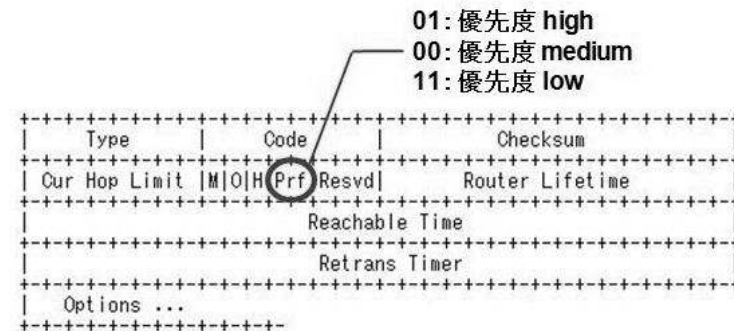
図 6 RA のメッセージフォーマット Fig. 6 A message format of Router Advertisement
