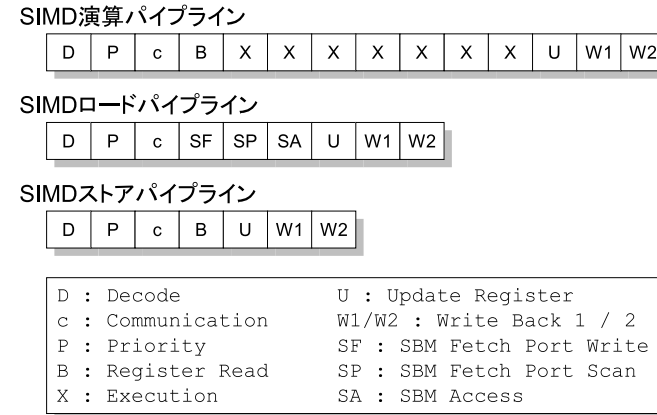
図 6 SIMD 実行パイプラインの構成 Fig. 6 Structure of SIMD execution pipeline.
