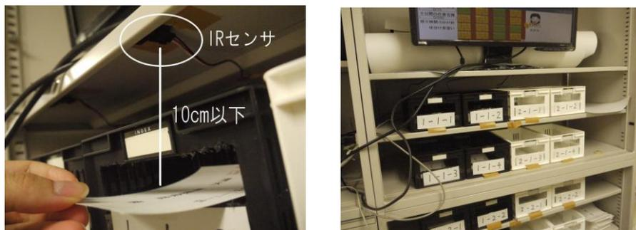
図10 赤外線反射センサの設置場所(左)と物理インタフェースの全景(右)
