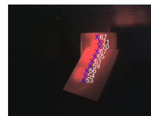
図 4 測距結果 X は横 1 ラインの分布の平均、整数値はカメラからの距離 [cm]
