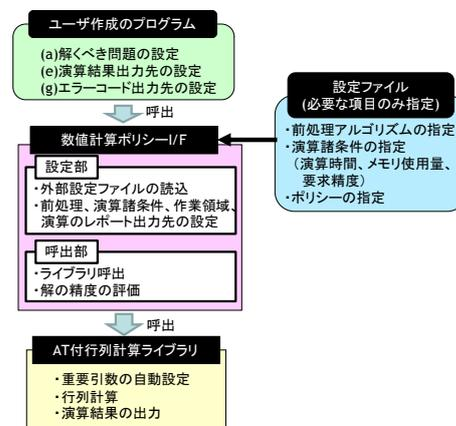
図1 メタインターフェース導入時の行列計算ライブラリの呼び出し方
