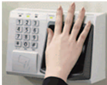
図-10 手のひら静脈認証入退室管理装置
