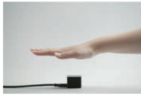
図-7 非接触型手のひら静脈認証センサ (35mm × 35mm × 27mm)
