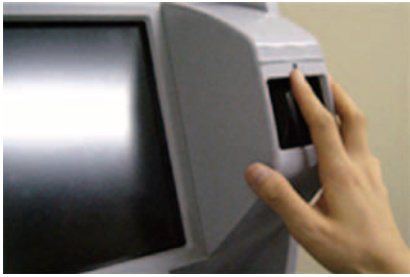
出典) 日本電気 (株) プレスリリース。 図-4 日本電気 (株) の指静脈認証方式
