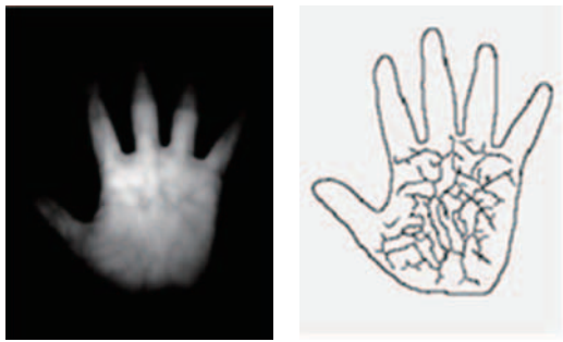
(a) 近赤外線による撮影画像例 (b) 静脈抽出画像例 図-6 非接触型手のひら静脈認証センサの画像例
