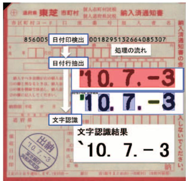
図-3 日付印認識処理の流れ
