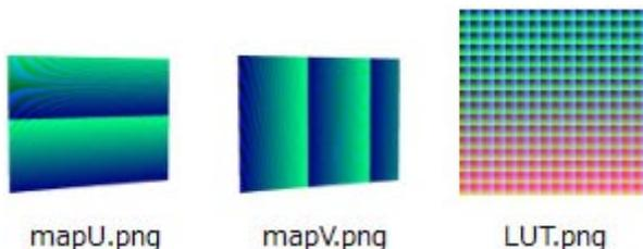
図6 作成された位置変換テーブルと色変換テーブル。
