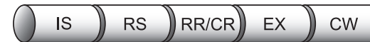
図5 回路面積指向レジスタ・キャッシュを用いたときのパイプライン Fig. 5 Instruction pipeline on a processor with an area-oriented register cache.
