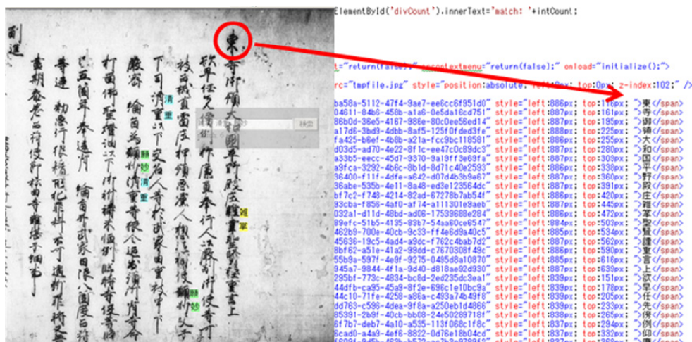
図3 Javascript による検索・ハイライト表示機能をもつ html ファイル
