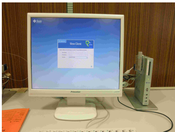
図 2 SunRay 端末：Windows ログイン画面 Fig. 2 Sun Ray terminal: login window for Windows
