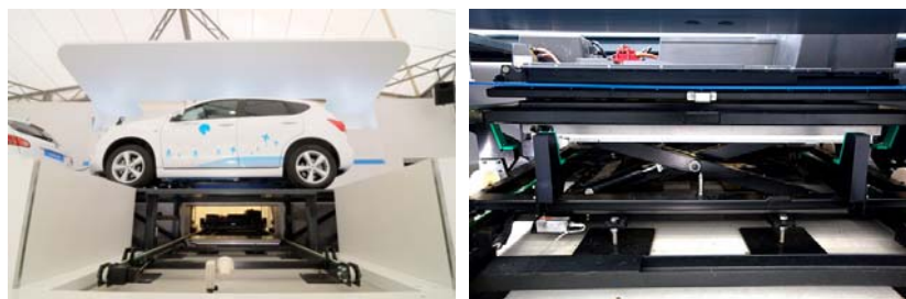
バッテリー交換ステーション
