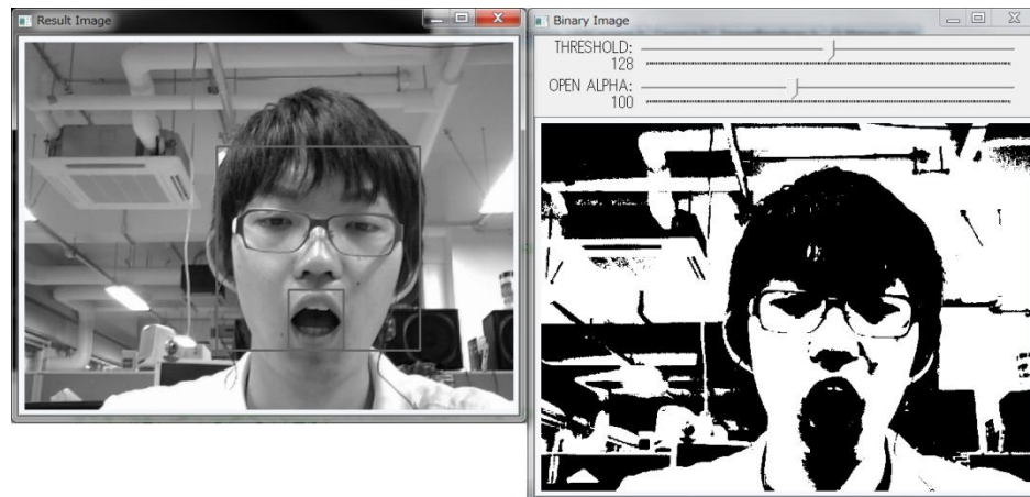
図 5 二値化閾値と口唇形状判定の重み調整画面 (右ウィンドウ上部のスライダーによって調整を行う)
