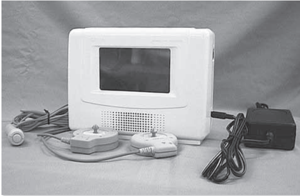
図-10 モバイルによる伝送システム。小型軽量のモバイル胎児心拍検出装置は幅 240mm、高さ 180mm、厚さ 90mm、2.0kg で、非常に使いやすい。
