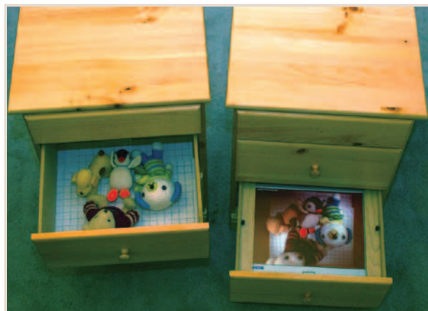
図-1 Peek-A-Drawer: ネットワーク接続したキャビネットの上の引き出しの内容が、もう一方の下の引き出しのディスプレイに表示される
