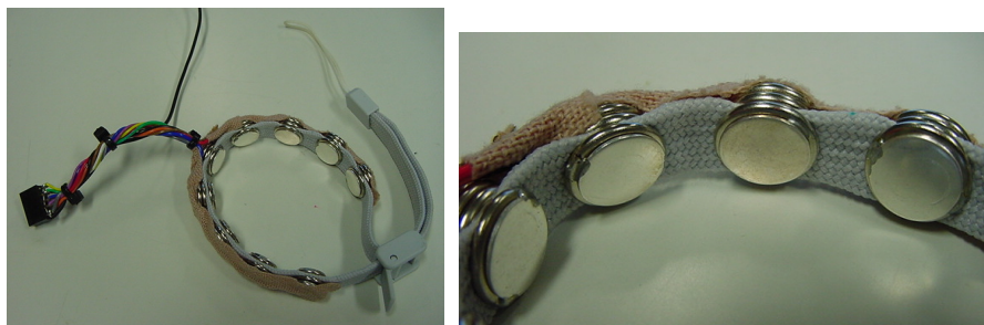
図 4 純銀円盤電極による筋電ベルトの外観(左)と電極のアップ(右)
