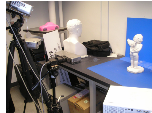
図6 実験システム全景．プロジェクタは 3 台用い，対象物体は拡散反射が支配的な反射特性である，石膏でできた像を選んだ．
