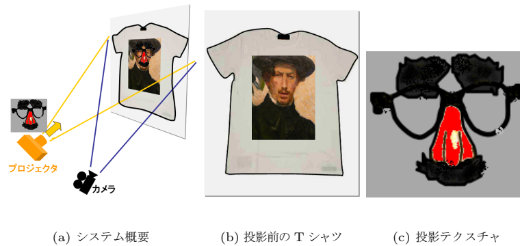
図 1 プロジェクタを用いた非剛体への動的テクスチャリング
