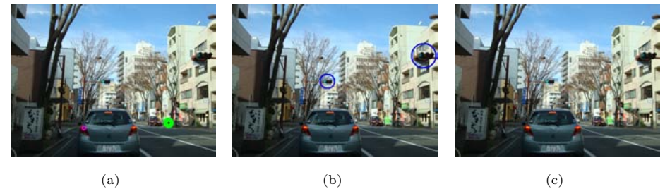
図 7 灯火の検出失敗による信号機非認識。(a) は信号機灯火の候補を検出し, 表示した図。(b) は Haar-like 特徴+AdaBoost の学習結果により信号機を検出した図。(c) は (a) と (b) より検出された信号機領域。
